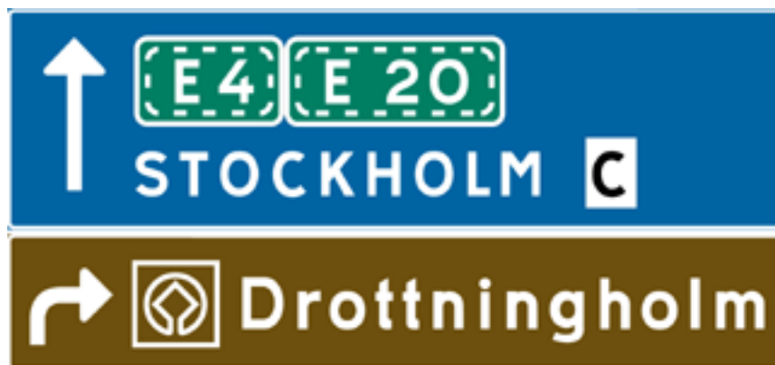
Figur 4. Exempel på tabellvägvisare där endast brun bottenfärg används i den aktuella riktningen.
